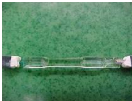
図5 ハイパワー試験後の光スプリッタの内部
